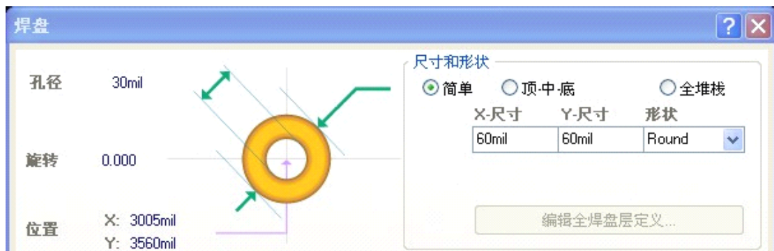
图 4-11-1 焊盘形状和尺寸
