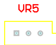
图 4-11-10 电位器的封装
