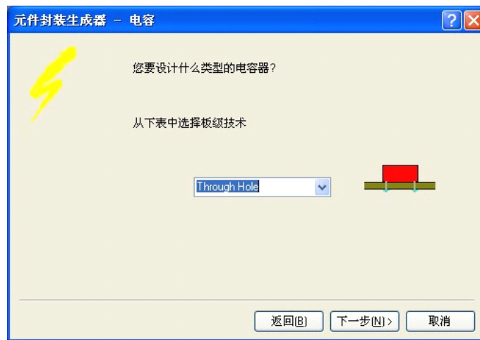
图 5-14-3 “选择电容封装类型”对话框
